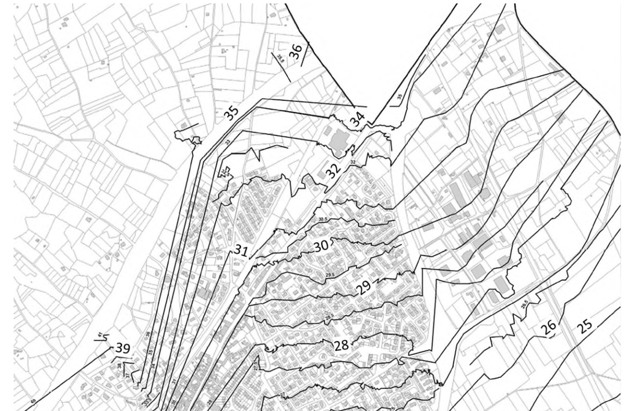
Illustration 45 : PHE disponibles dans le PPRI de la commune de de Milhaud (BRL, avril 2014).
