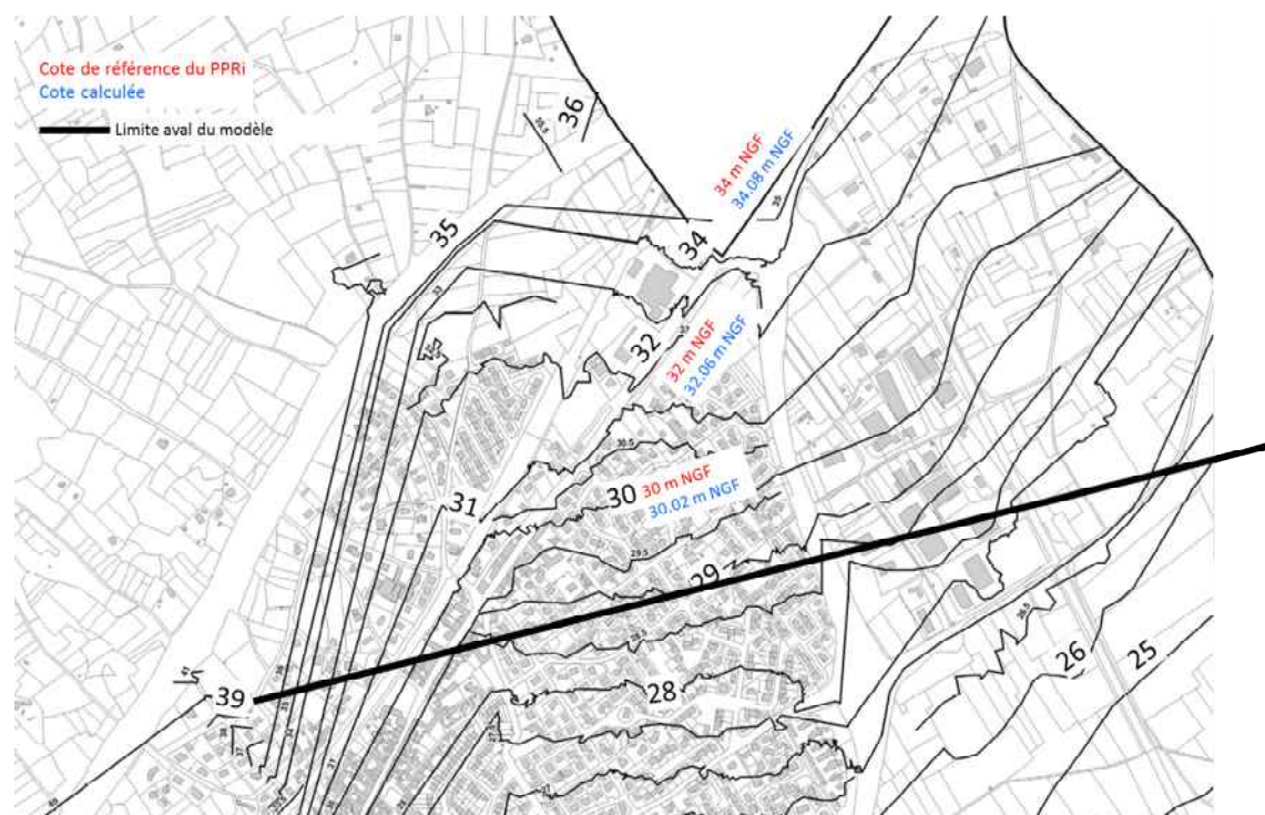
Illustration 83 : Calage du modèle J - Comparaison des cotes de référence du PPRI de Milhaud et des cotes calculées
