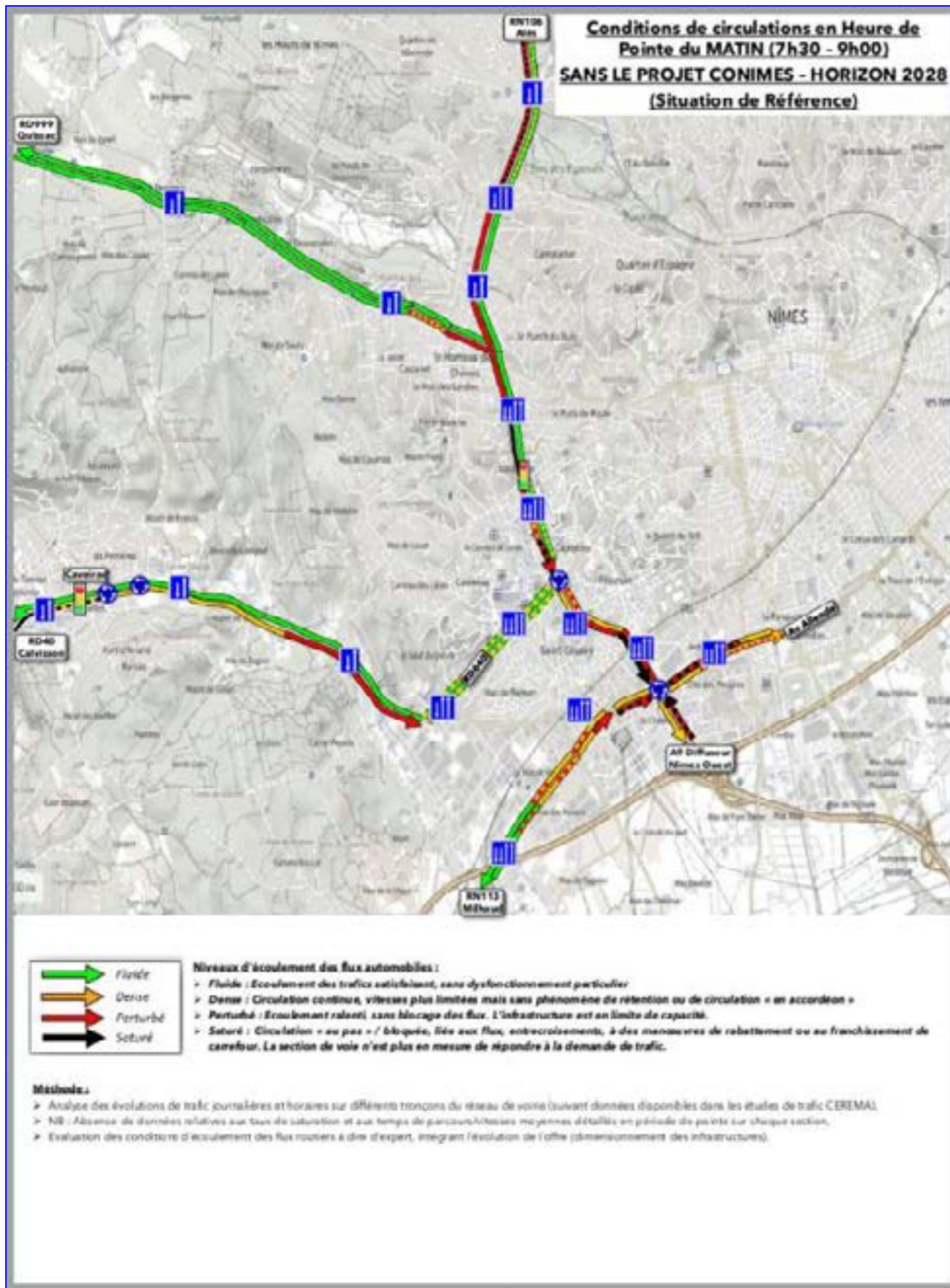
Illustration 178: Condition de circulation pour le scénario de référence en heure de pointe du matin (Source Horizon conseil, 2022)
